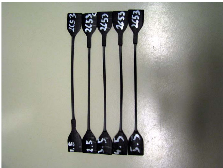
Bild 11: Zugproben nach Versuch
