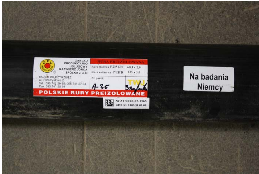
Bild 1: Aufkleber auf Mantelrohr, Prüfling 2653
