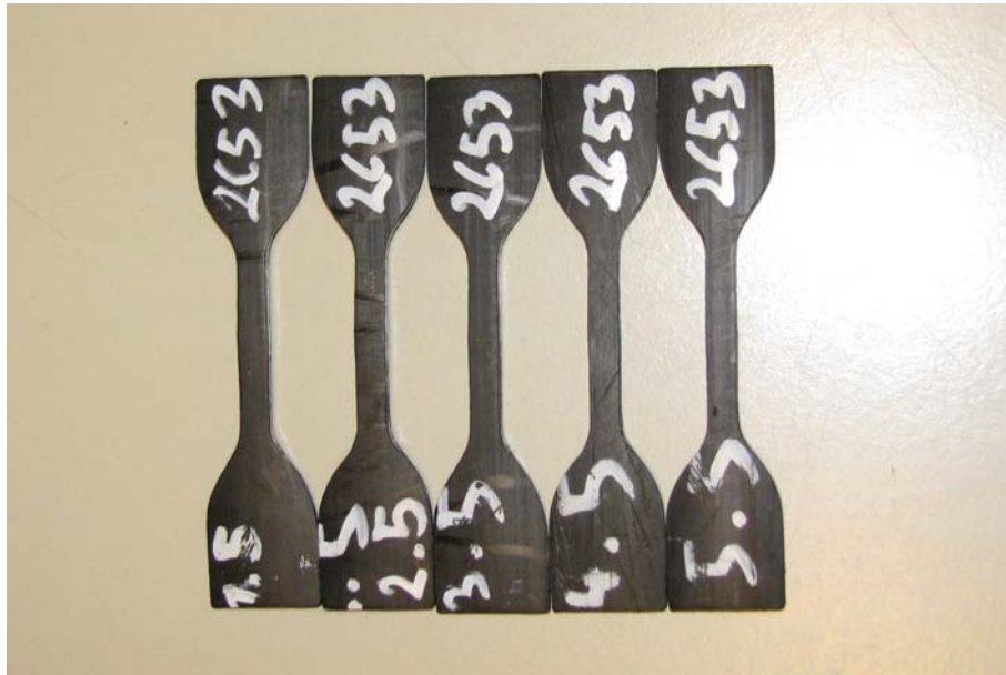
Bild 10: Zugproben vor Versuch
