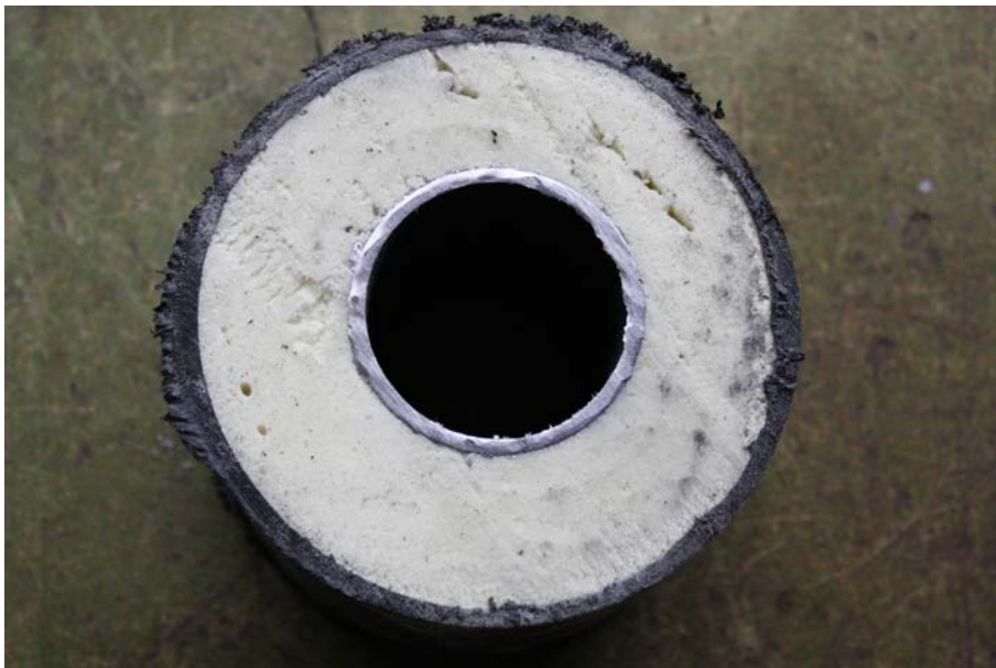
Bild 6: Untersuchung auf Lunker und Blasen, Querschnitt Nummer 2
