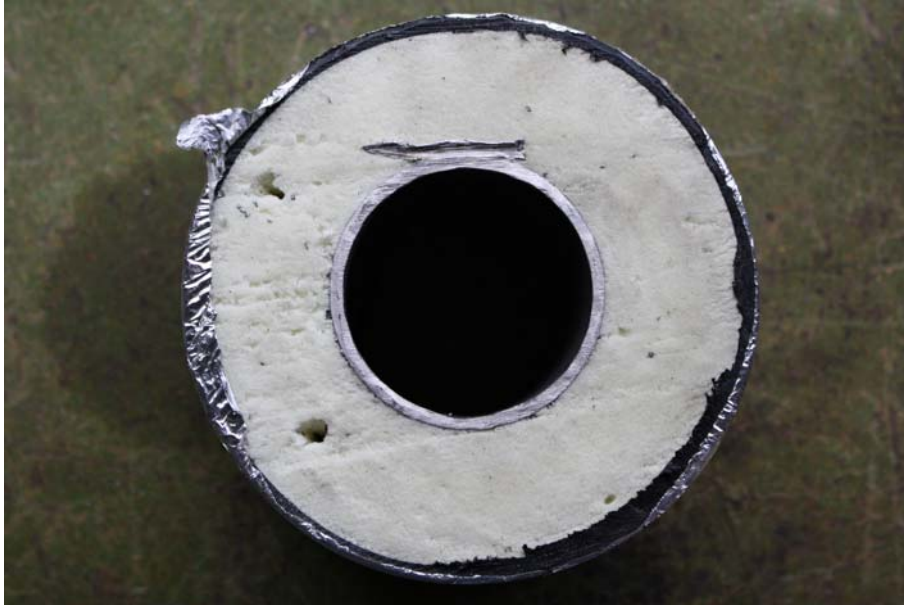
Bild 9: Untersuchung auf Lunker und Blasen, Querschnitt Nummer 5
