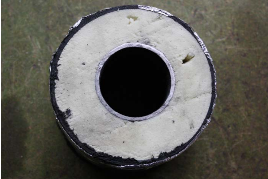
Bild 5: Untersuchung auf Lunker und Blasen, Querschnitt Nummer 1
