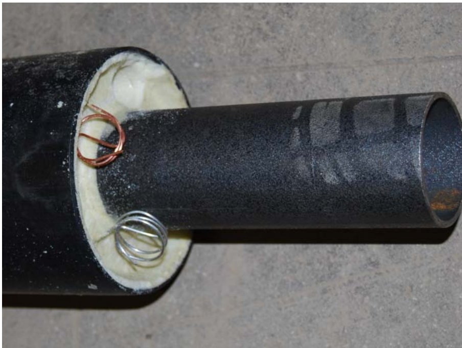
Bild 4: Rohrende mit gesandstrahltem Mediumrohr, Prüfling 2688
